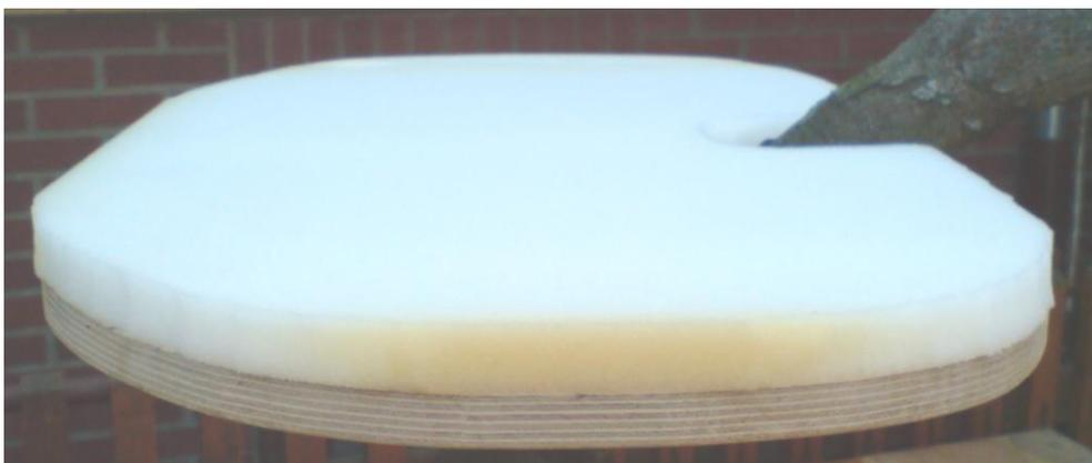
Anschließend wurden die zwei Schaumstoff-Spanplatten mit Stoff bespannt. Es zeigte sich, dass wuscheliger Stoff sehr gut geeignet ist, um die Krampen zu vertuschen. Überstehende Krampen wurden mit dem Hammer endgültig versenkt.
